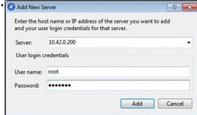
Indicar o enderezo IP ou o nome (se está dado de alta no DNS) do servidor a xestionar: neste caso 10.42.0.200. Indicar tamén as credenciais de autenticación.
