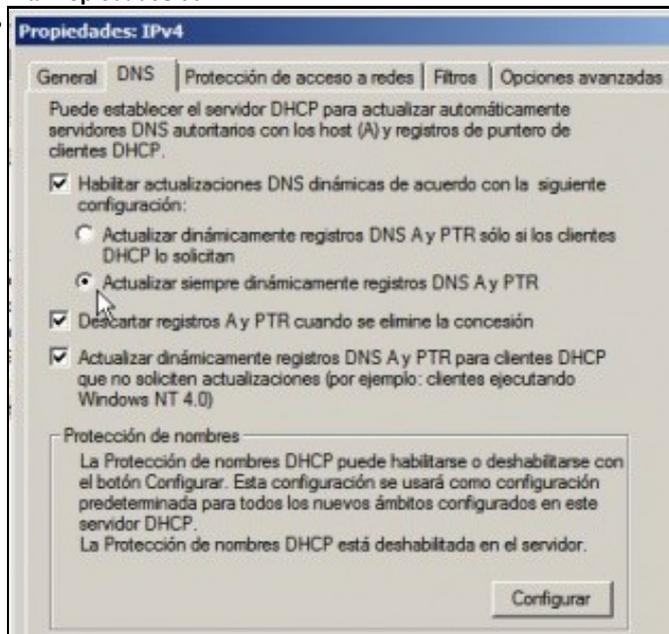
Pensando en todo tipo de dispositivo que se poida ter na rede LAN e que sexa cliente DHCP vaise activar que o servidor DHCP registre toda asignación de IPs no servidor DNS.
