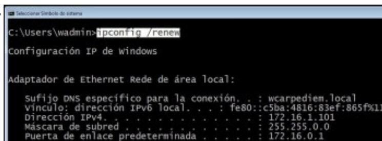
En **wclient** renovar a configuración IP con **ipconfig /renew**. Comprobar a IP asignada.
