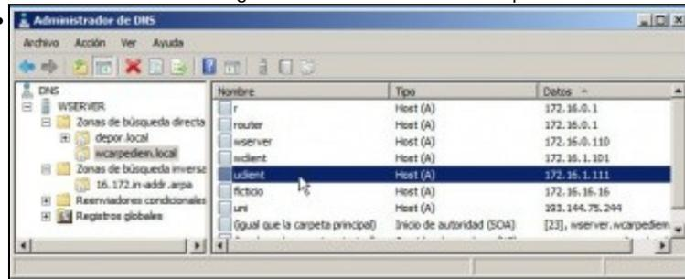
En **wserver** comprobar na zona **wcarpediem.local** o servidor DHCP deu de alta o host **uclient** coa súa nova IP.
