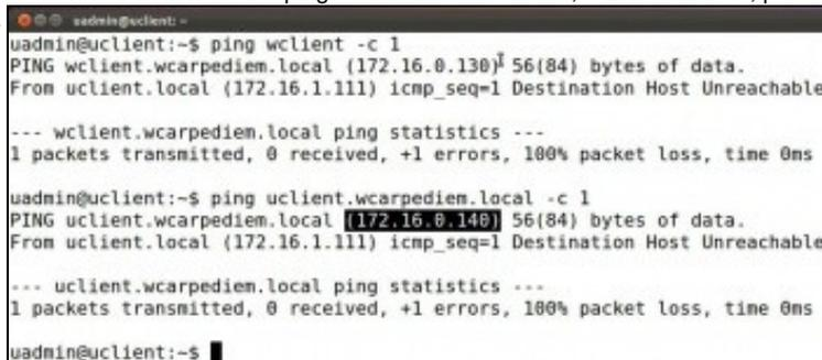
O mesmo pasa en uclient. E claro, non se vai estar cambiando manualmente no servidor DNS á IP dos hosts en función do que vai asignado o servidor DHCP.
