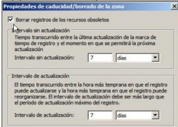
E marcar que se borren os rexistros obsoletos. Así de vez en cando o servidor DNS vai eliminando aqueles rexistros polos que se leva un
