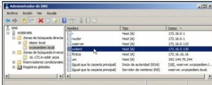
Non faría falla eliminar ningún host dos implicados, pois cando estea todo activado e o host pida de novo a IP o servidor DHCP xa se vai encargar de actualizar o rexistro nas 2 zonas de busca (directa e inversa). Para este exemplo elimínouse wclient e deixouse wserver.
