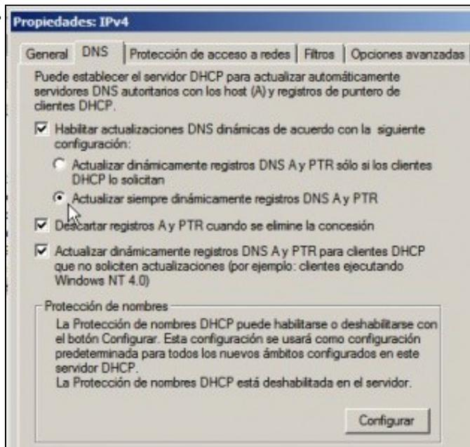
Pensando en todo tipo de dispositivo que se pueda tener en la red LAN e que sea cliente DHCP va a ser activado que el servidor DHCP registre toda asignación de IPs no servidor DNS.
