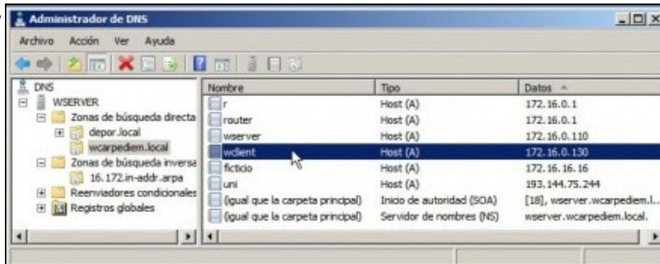
Non faría falla eliminar ningún host dos implicados, pois cando estea todo activado e o host pida de novo a IP o servidor DHCP xa se vai encargar de actualizar o rexistro nas 2 zonas de buas (directa e inversa). Para este exemplo elimínouse uclient e deixouse wclient.
