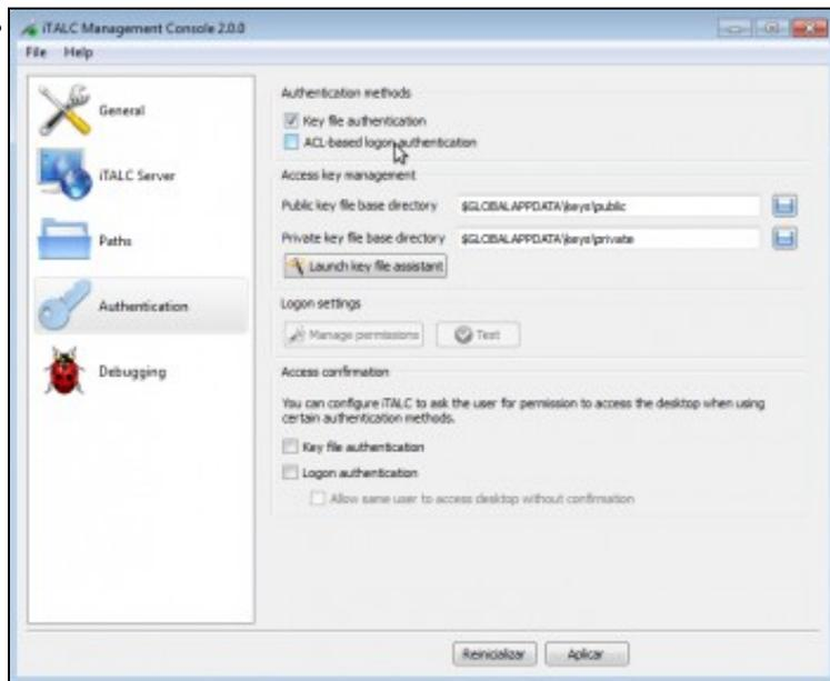
Imos desmarcar a autenticación baseada en ACLs (*ACL-based logon authentication*), xa que só imos usar de momento a autenticación por claves. Picamos no botón de **Aplicar** para activar todos os cambios.
