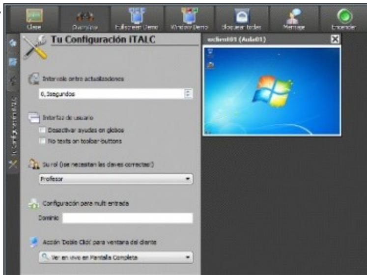
No apartado de *Configuración de Italc* da barra lateral podemos configurar algúns aspectos, como a velocidade de refresco das capturas na monitorización dos equipos (con menos intervalo de refresco a calidade de visión é mellor pero se xenera máis tráfico na rede), o rol que se utilizará ao conectarse coas máquinas dos alumnos e que acción queremos facer ao facer dobre clic sobre a vista da pantalla dun alumno (visualizar o seu escritorio a pantalla completa ou tomar o control).
