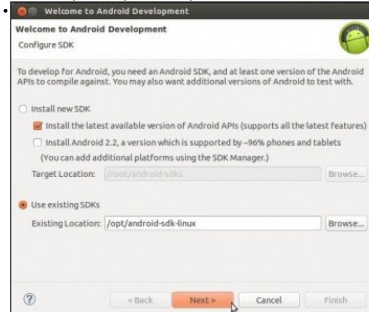
Unha vez instalado o Plugin ADT en Eclipse este permítenos que instalemos un novo SDK de Android descargándoo dende cero, ou usar un xa instalado. Escoller esta segunda opción e indicar a ruta **/opt/android-sdk-linux**
