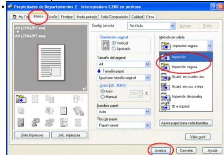
Escolemos en "Método de salida" Impresión ou Impresión segura según queramos e "Aceptar".
