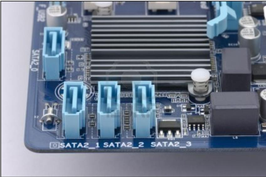
En esta imagen puede verse una controladora SATA, a la que se pueden conectar dispositivos (discos, unidades ópticas) que se adapten a esa especificación de interfaz
