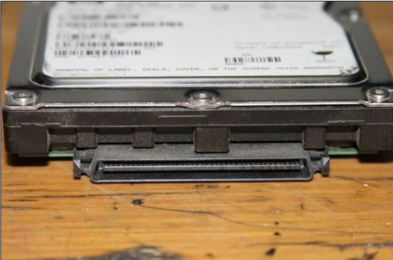
Imagen de un disco de tipo SCSI. Todos los discos de este tipo, independientemente del fabricante, se conectan de un mismo modo a la placa, a través de una controladora SCSI en ésta. En la imagen puede verse claramente el conector SCSI que permitirá conectar el disco a la controladora en la placa base.
