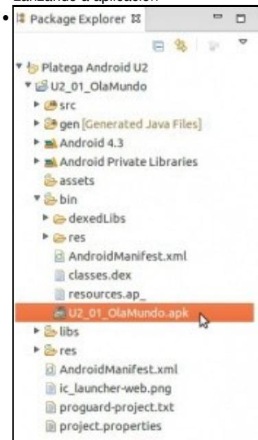
O ficheiro **apk** que permite instalar a aplicación nun dispositivo e que Eclipse o fai por nós.
