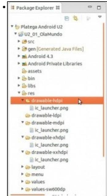
/res/drawable-X: almacenan as imaxes da aplicación en función da densidade (dpi) do dispositivo de destino.
