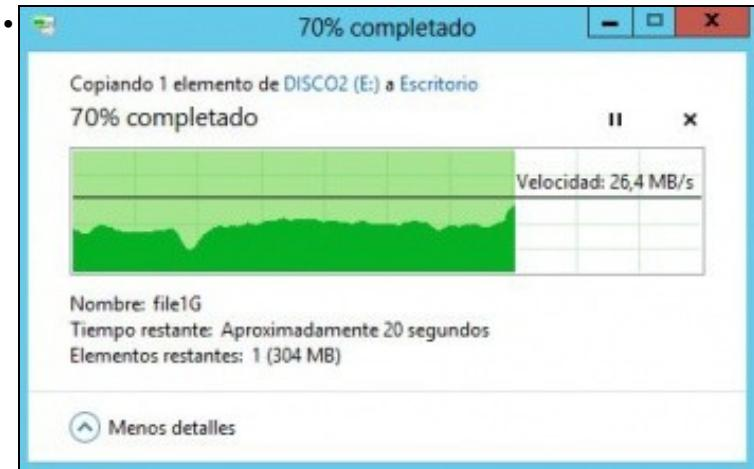
Copiamos ao escritorio o ficheiro de 1 GB, desconectamos o cable dun adaptador e vemos a baixada de rendemento debido a unha parada na transmisión até recuperarse. Volvemos a conectar o cable e ...
