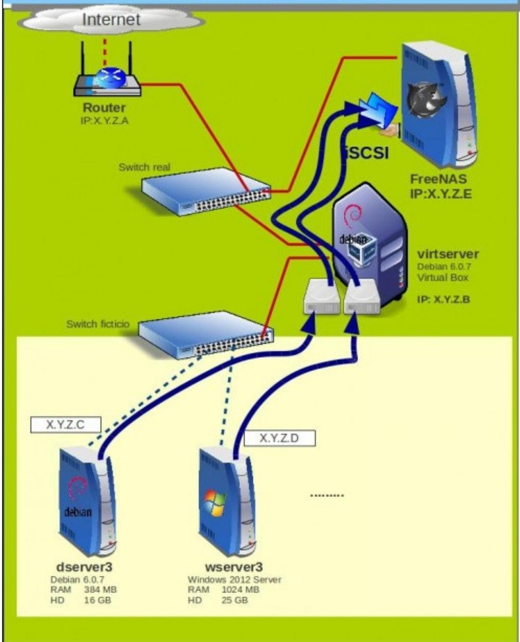
Para acadar un maior rendemento, sería preferible utilizar un switch unicamente para as conexións iSCSI (formando así unha SAN) e outro para a conexión a Internet ou outras conexións da LAN, pero neste caso omitiuse a súa inclusión para non complicar en exceso o esquema.
