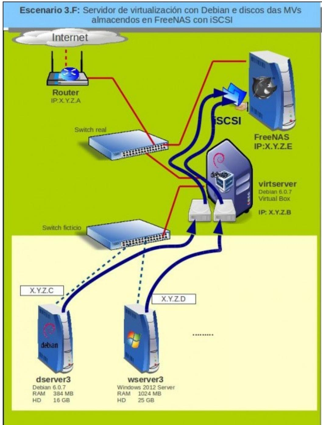
Para acadar un maior rendemento, sería preferible utilizar un switch únicamente para as conexións iSCSI (formando así unha SAN) e outro para a conexión a Internet ou outras conexións da LAN, pero neste caso omitiuise a súa inclusión para non complicar en exceso o esquema.
