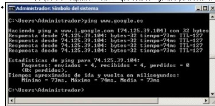
Para probar a conectividade pódese facer ping ao equipo host, ao router real, ao exterior, etc. Neste caso faise ping a [www.google.es](http://www.google.es) que se funciona é que hai conectividade co host e co router real. Obviamente dende o host e dende a LAN non hai conectividade con **wrouter**
