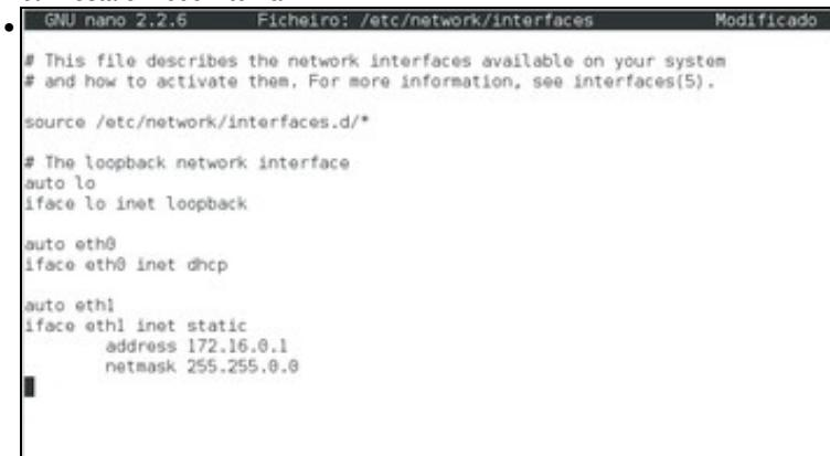
Debemos configurar a interface NAT de forma automática por DHCP e a que está en rede interna coa dirección 172.16.0.1. Podemos facelo de calquera das formas xa vistas no curso, na imaxe móstrase como facelo utilizando o ficheiro de configuración das interfaces en Debian.
