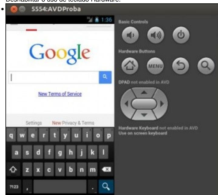
Iniciar o dispositivo e ir ao navegador, observar como para teclear hai que facer uso do teclado en pantalla do AVD.
