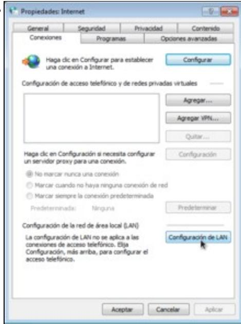
Imos á pestana de **Conexions** e picamos no botón de **Configuración de LAN**.
