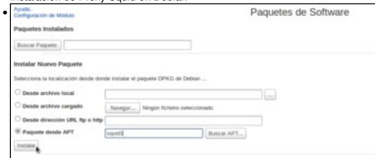
Usamos a ferramenta de **Paquetes de Software** para instalar usando *apt* o paquete **squid3**.
