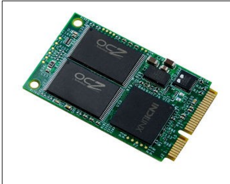
Disco de estado sólido con conexión mSATA para o conector anterior
