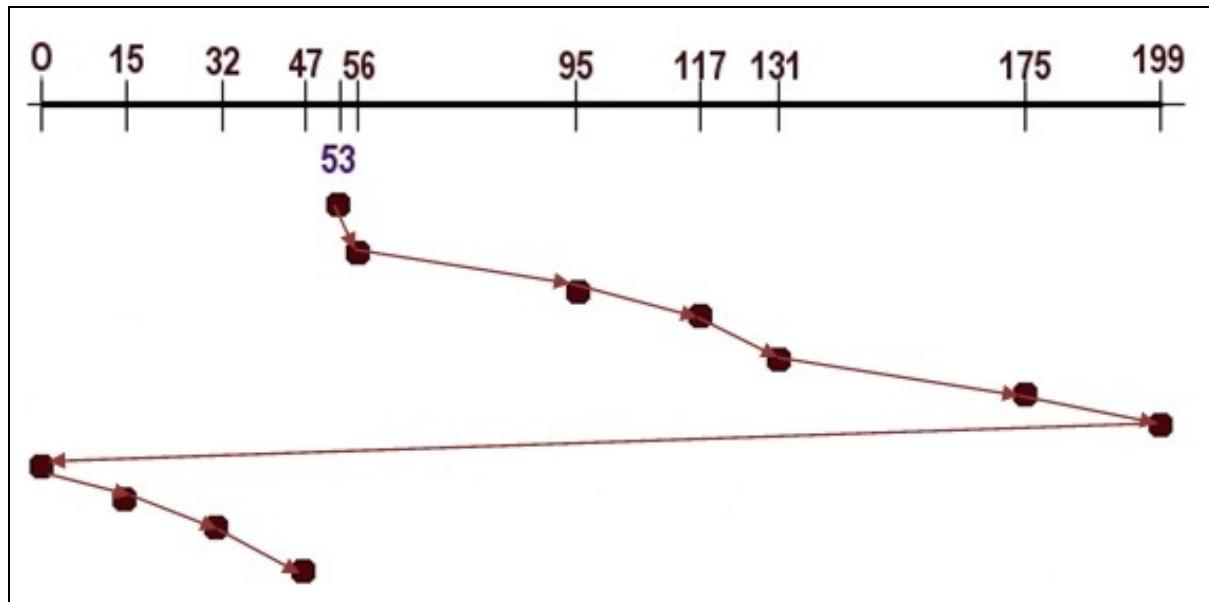
Como podemos ver na imaxe determinamos que o movemento total do cabezal para satisfacer as solicitudes da cola toma o valor de 390 cilindros. Isto calcúlase sumando o desprazamento do cabezal entre as solicitudes executadas. Así,
