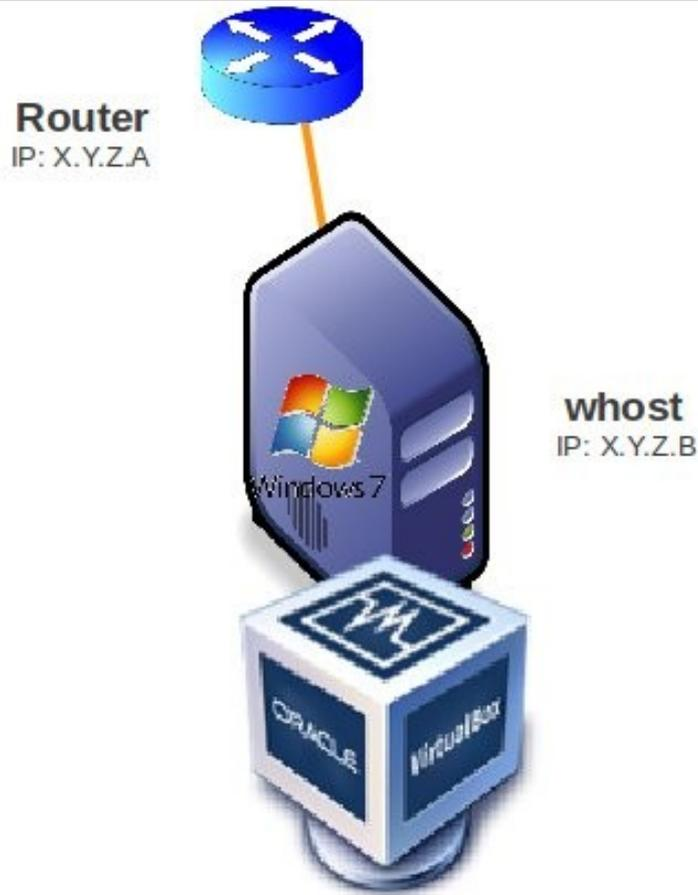
Neste segundo escenario instalase a ferramenta VirtualBox sobre un equipo físico co sistema operativo MS Windows.
