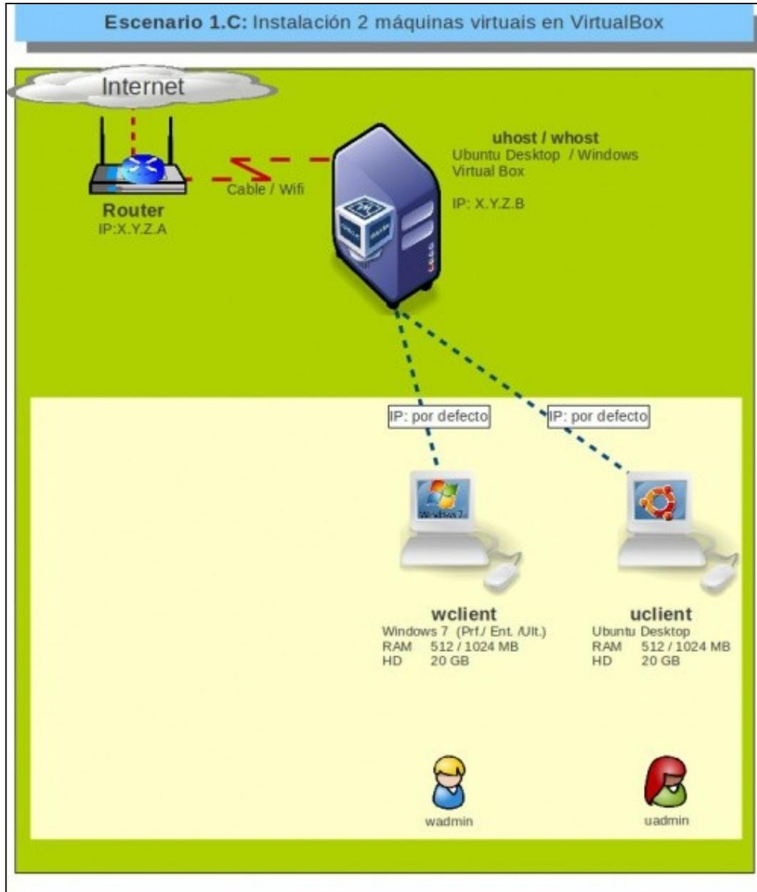
Este escenario amosa un equipo físico "host" con 2 máquinas virtuais instaladas.
