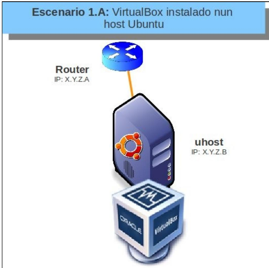
Neste primeiro escenario instalase a ferramenta VirtualBox sobre un equipo físico co sistema operativo Linux (Ubuntu).
