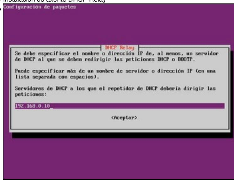
A continuación o configurador do paquete preguntanós cal é o enderezo do servidor DHCP ao que se van retransmitir os paquetes que teñan que ver con DHCP.
