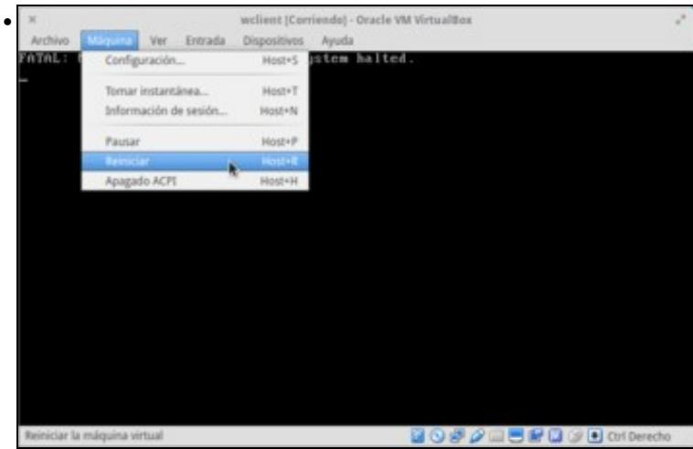
Volver a apagar a máquina polo método anterior ou reiniciala no menú da MV: **Máquina:Reiniciar** ou a tecla de **host+R** (isto é, **CTRL DEREITA + R**)
