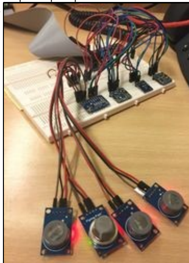
Montaxe dos sensores na proto-board.
