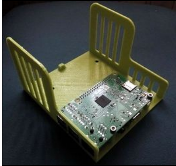
Imaxe da parte inferior da caixa recién impresa e coa Raspberry xa anclada nela (esta peza tarda unhas 3 horas en imprimirse).
