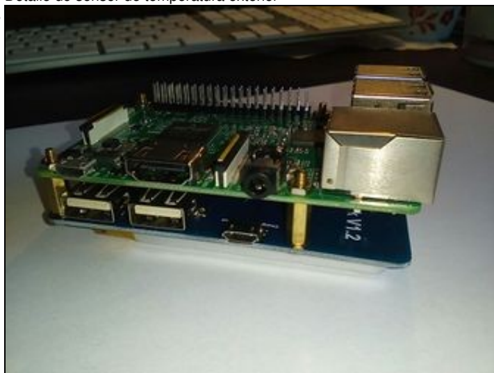
RaspberriPi montada co alimentador lipo externo
