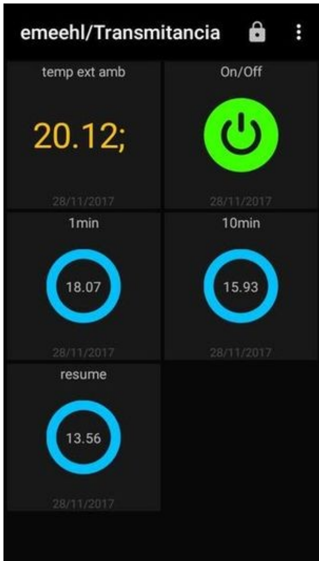
Control do termofluxómetro usando dispositivo Android
