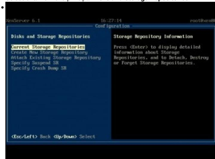
Os repositorios de almacenamento (**Storage Repositories, SR**) úsanse fundamentalmente para conter discos virtuais para ser usados polas MVs, ademais os SR poden conter un repositorio de imaxes ISO con sistemas operativos para instalar nas MVs. Pódense crear repositorios con discos locais ou con almacenamento remoto. Na parte VII afondarase máis neste menú.
