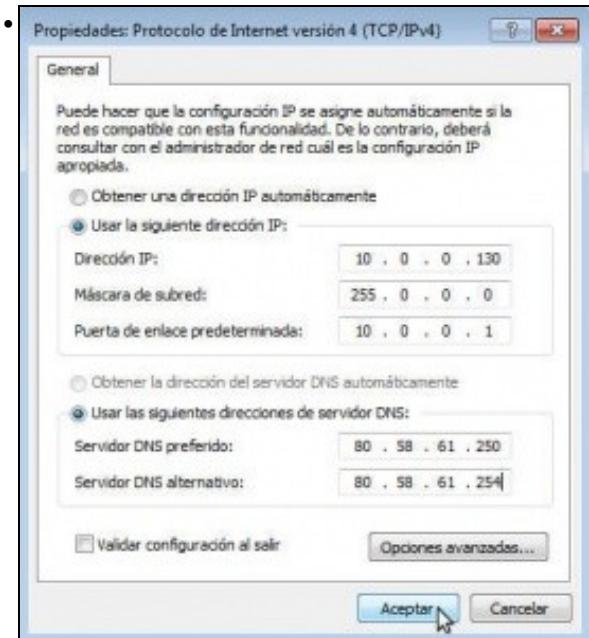
Configuramos manualmente a configuración IP da MV: DNS, Porta de Enlace e Máscara: os mesmos que os do host. A dirección IP debe estar na mesma rede-IP que o *host* e que non choque con outro dispositivo da LAN.
