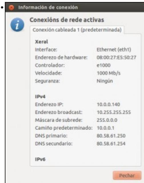
Conexión coa nova IP. Se non tivera a IP correcta, na imaxe anterior a esta, premer en **Activar rede**, para parar o servizo de rede e volver a premer en **Activar rede** para activalo coa nova configuración.
