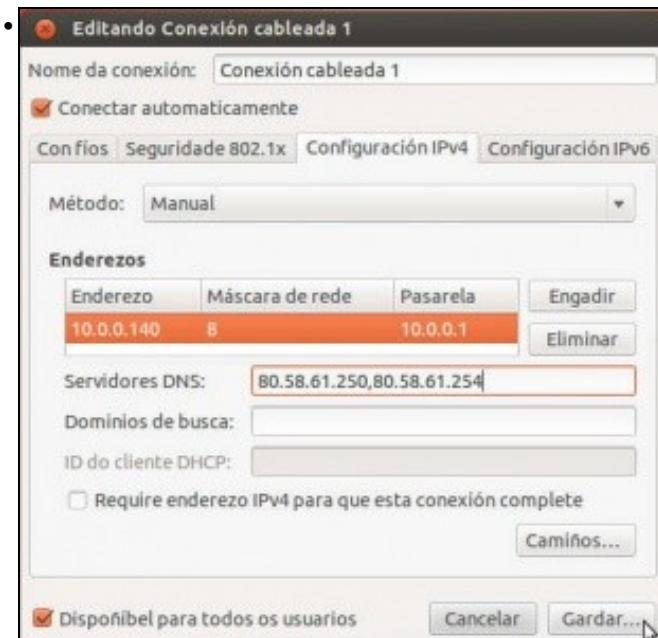
Na lapela **Configuración IPv4** seleccionar: **Método:** manual. Premer en **Engadir**, cubrir o campo da IP, premer a tecla de tabular e xa nos pon a máscara. Rematar de cubrir os campos atendendo a: DNS, Porta de Enlace e Máscara: os mesmos que os do host. A dirección IP debe estar na mesma rede-IP que o host e que non choque con outro dispositivo da LAN. Observar como se indican os DNS separados por comas.
