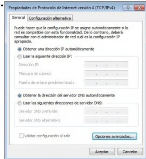
A configuración IP está preparada para que os datos se obteñan por DHCP. Se hai un servidor DHCP na LAN, este vaille dar unha IP á MV
