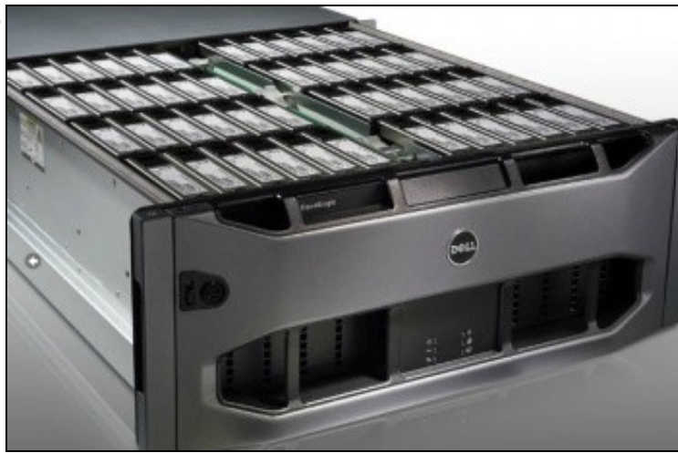
Conxunto de discos da cabina.
