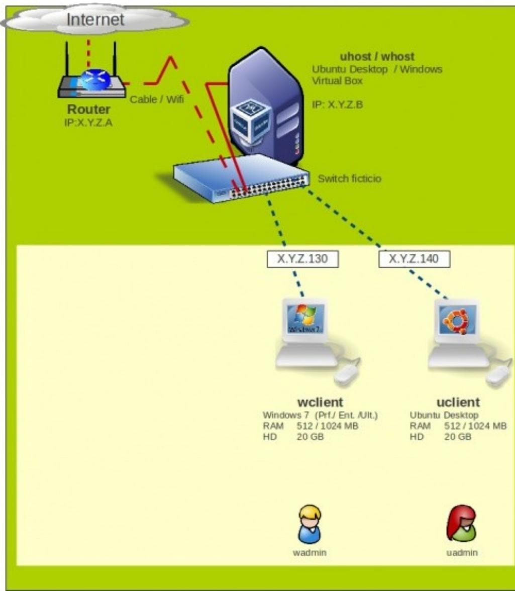
Neste escenario os equipos virtuales compórtanse como se fosen equipos reais e poden comunicarse con calquera elemento da LAN e calquera elemento da LAN con eles.
