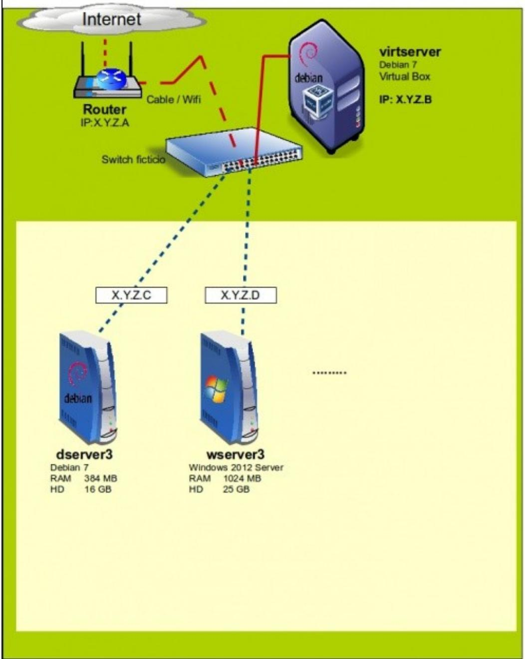
Configuración dun equipo físico como servidor de virtualización, co obxectivo de executar máquinas virtuais.
