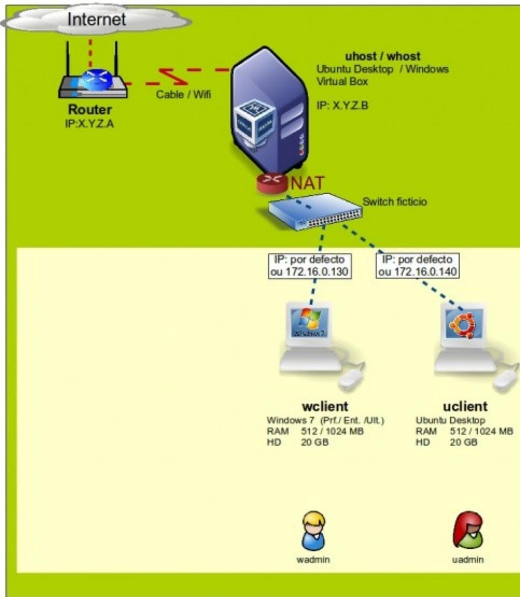
Este escenario amosa que as máquinas virtuais teñen as tarxetas de rede configuradas en modo de rede NAT, recentemente incluído en VirtualBox. Desta forma poden comunicarse entre si e acceder ao exterior.
