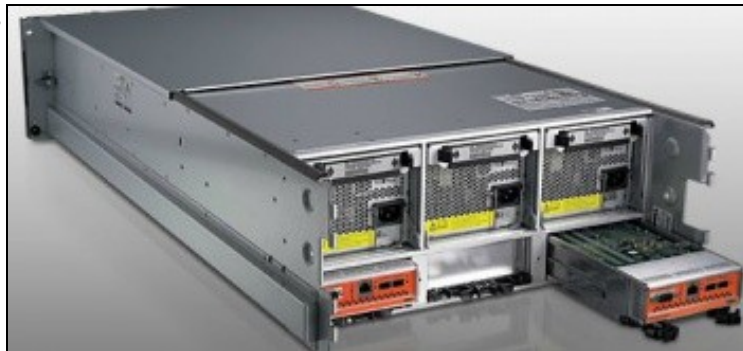
A parte traseira amosa 2 controladoras e cada unha delas amosa interfaces Ethernet (para iSCSI sobre TCP/IP) e conectores iSCSI para conectar ás HBAs.
