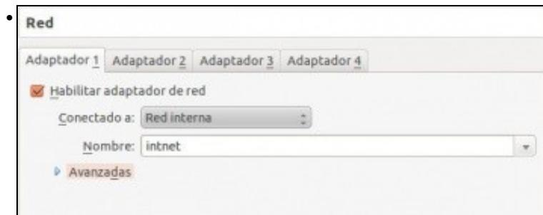
A MV **uclient** debe estar configurada cun único adaptador en modo **Rede interna** ou en modo **Rede NAT**.
