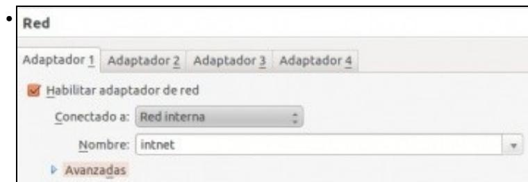
A MV **wclient** debe estar configurada cun único adaptador en modo **Rede interna** ou en modo **Rede NAT**.
