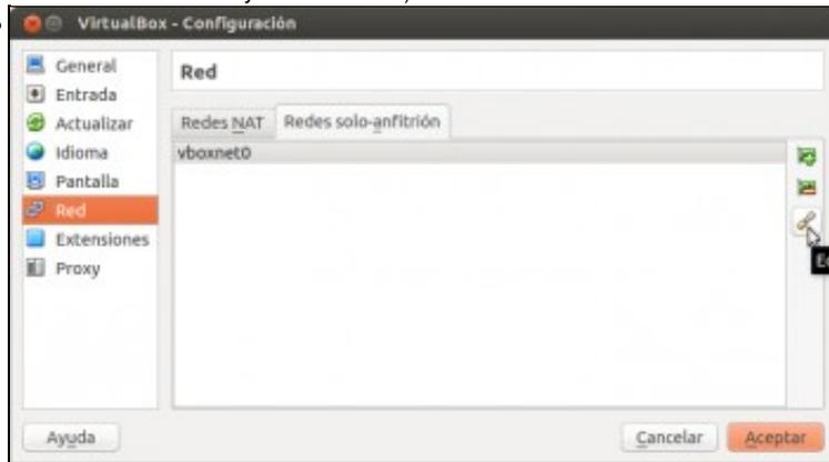
Edítalo. Este interface é como unha nova tarxeta que se lle engade ao host e sobre a cal se monta o switch ficticio. Esta tarxeta vai ter unha IP para o host e incluso pode actuar de servidor DHCP para as Máquinas Virtuais.
