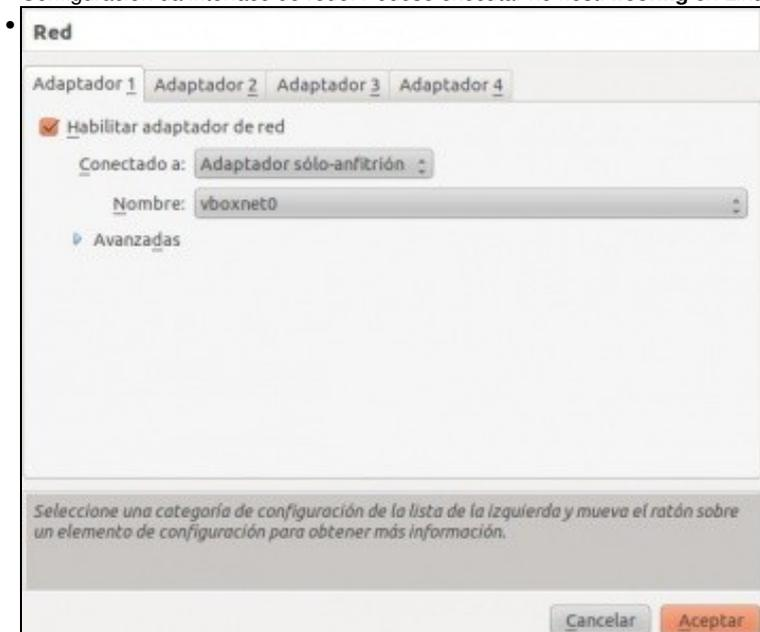
Configurar cada adaptador de rede de **wclient** e **uclient** como adaptador **Só-anfitrión**.
