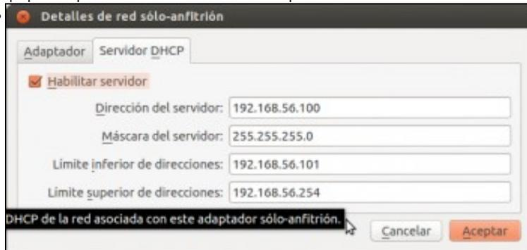
Configuración do servidor de DHCP para este novo interface. No noso caso non imos facer cambios, pero poderíanse cambiar os datos pola rede que se desexase.
