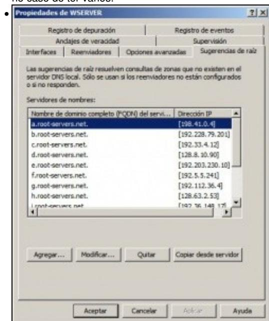
Na lapela **Suxerencias Raíz** pódense observar os enderezos IP dos servidores raíz, usados no proceso de recursividade.
