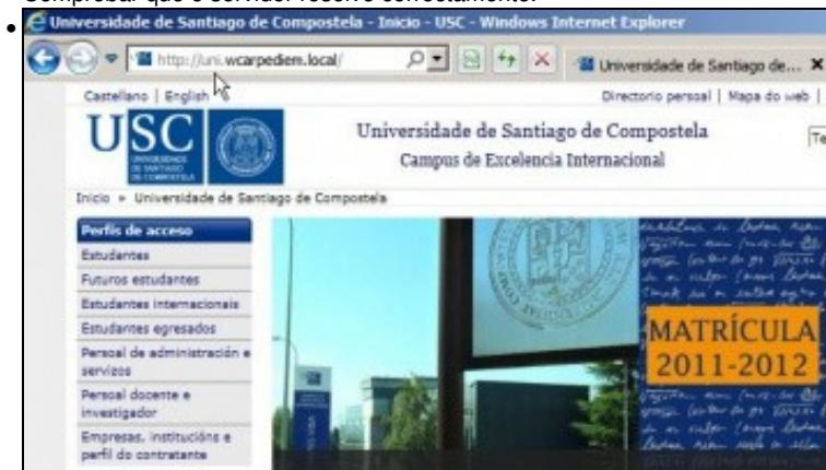
E nun navegador en **wserver** indicar a url: **uni.wcarpediem.local** e voilà aí está a páxina da Universidade. Pero ollo!!, isto é porque o servidor web da USC non está configurado para que haxa que poñerelle exactamente **www.usc.es** para que funcione. Recórdese tamén que para que este paso funcione correctamente debemos configurar o navegador para que non saia a internet a través do servidor proxy, porque senón sería o proxy o que resolvería o nome da URL.
