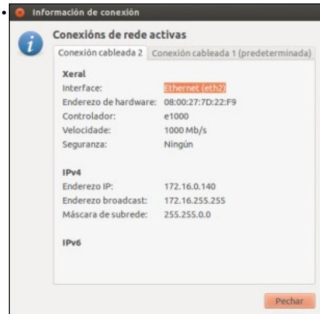
A **Conexión cableada 2** está correcta (senón habería que desconectala e volver conectala)
