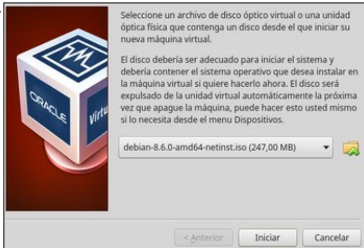
Iniciamos a máquina e xa se nos vai pedir o disco para iniciala. Seleccionamos a imaxe ISO descargada para a instalación e prememos en **Iniciar**.
