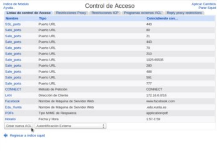
Dentro do apartado de **Control de acceso**, creamos unha ACL de tipo **Autenticación externa**.
