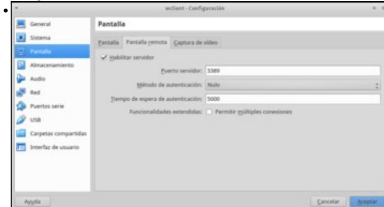
Neste caso, na máquina **wclient** habilitamos o servidor de escritorio remoto no porto 3389 da máquina host. VirtualBox permite utilizar mecanismos de autenticación para poder conectarse á máquina, que poden ser externos ou do propio VirtualBox, pero non imos usar ningún.
