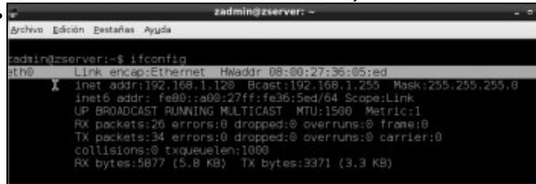
Na liña de comandos executar **ifconfig** e observar como **eth0** está asociada á MAC da primeira imaxe e á IP que se configurou cando se instalou a MV.
