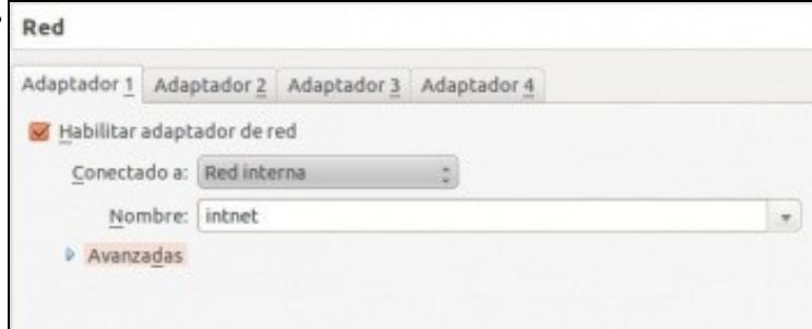
A MV **uclient** debe estar configurada cun único adaptador en modo **rede interna**, ou **rede NAT** se se omite o uso da máquina que fai de router.
