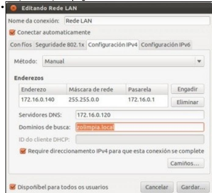
Imos engadir un sufijo DNS de modo que cando se poña un simple nome de equipo, este sexa completado co resto do nome do dominio automaticamente. Na configuración da interface de rede de **uclient** anexar o sufijo deseñado (pódense anexar tantos como se desexen, separados por comas): **zolimpia.local**. Gardar e ...
