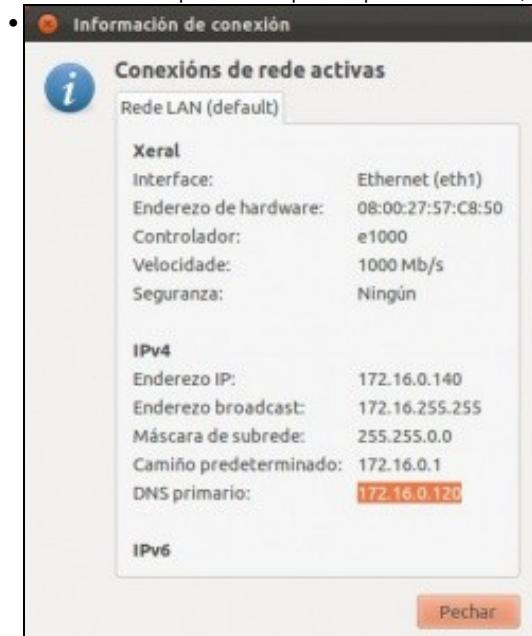
A conexión de rede configurada. Se non estivera configurada correctamente, lembrar que se pode desactivar a conexión de rede e volvela activar e así xa carga a nova configuración.
