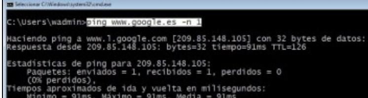
Proba de conexión ao exterior: funciona o servidor DNS (resolveu por recursividade) e o funciona o router, pois estamos encamiñando a través de 172.16.0.1.
