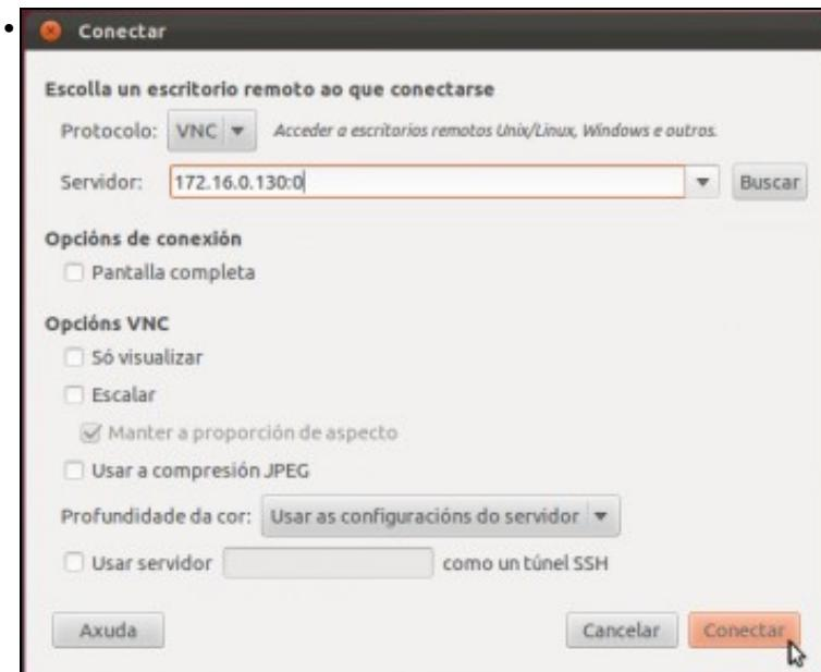
Lanzamos o visualizador de escritorios remotos e picamos en **Conectar**. Seleccionamos protocolo VNC, introducimos a dirección IP do equipo seguida de ":"0" (igual que cando nos conectamos usando o UltraVNC en Windows, neste caso é más cómodo) e picamos en **Conectar**.
