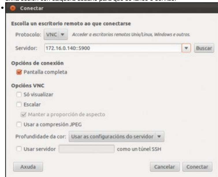
Imaxe dun cliente Ubuntu (estase usando o equipo que nos anteriores apartados se usou como servidor VNC) conectándose ao servidor VNC.
