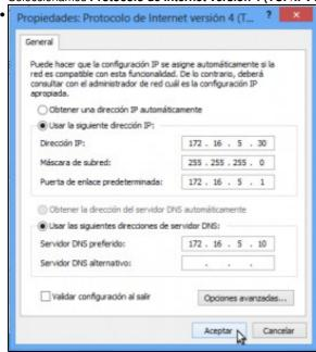
Como servidor de DNS introducimos a dirección IP do equipo debian.
