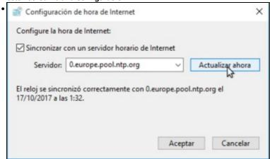
Activamos a sincronización con un servidor de hora, e introducimos o mesmo servidor que configuramos no equipo debian: **0.europe.pool.ntp.org**. Picamos en **Actualizar agora** para comprobar que funciona a sincronización.
