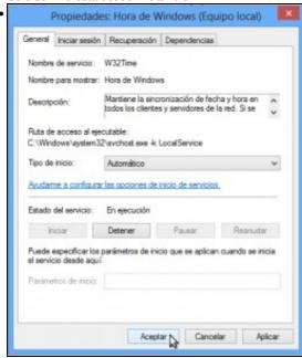
No Tipo de inicio, seleccionamos Automático para que o servizo se inicie automaticamente no arranque do sistema.
