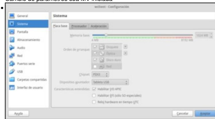
Se a máquina virtual está acesa ou ten o estado gardado, a meirande parte dos parámetros non poden modificar. Como vemos na imaxe, non podemos cambiar a cantidad de RAM da MV. Isto ten todo o sentido, xa que non se pode cambiar "en quente" a memoria RAM dun sistema, se fose unha máquina física teríamos que apagala para ampliarlle a RAM.
