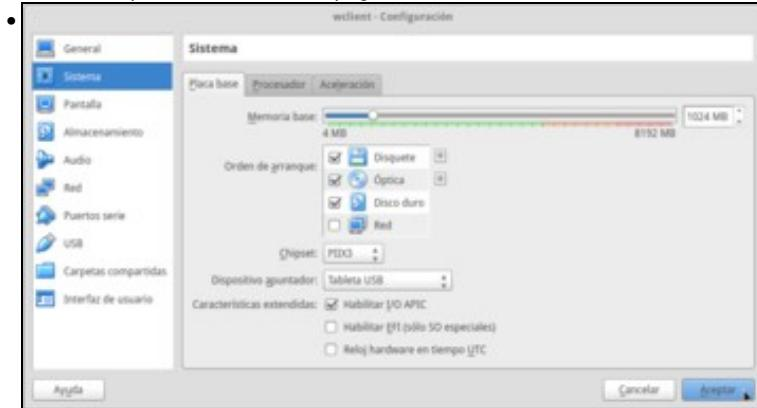
Con máquina virtual apagada, poderemos cambiar calquera parámetro de configuración da mesma. Un dos más frecuentes é a cantidade de memoria RAM asignada á máquina, que como se ve na imaxe ampliamos a 1GB.
