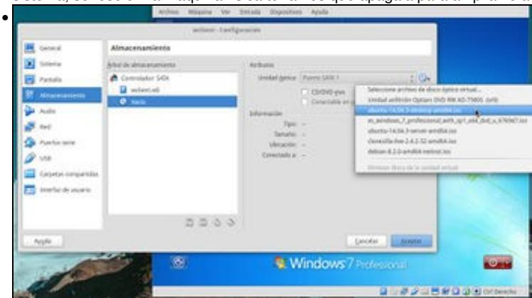
Tampouco podemos engadir ou quitar discos, pero si podemos cambiar o disco enlazado nas unidades de almacenamiento extraíbles (na unidade de CD/DVD e disquete). O que se está facendo na imaxe equivale a meter un CD se a máquina fose unha máquina física.
