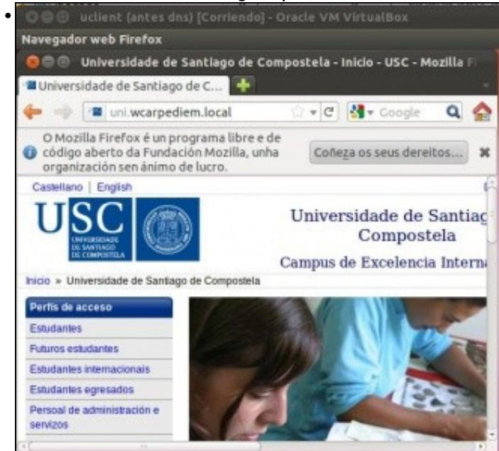
Comprobar que se pode navegar pola url [uni.wcarpediem.local](http://uni.wcarpediem.local). Recórdese que para que este paso funcione correctamente debemos configurar o navegador para que non saia a internet a través do servidor proxy, porque senón sería o proxy o que resolvería o nome da URL.
