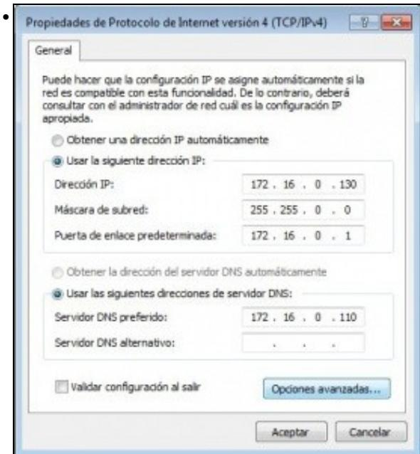
Imos engadir un sufijo DNS de modo que cando se poña un simple nome de equipo, este sexa completado co resto do nome do dominio automaticamente. Na configuración da interface de rede de **wclient** premer en **Opciones avanzadas**.
