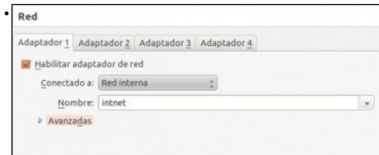
A MV **uclient** debe estar configurada cun único adaptador en modo **Rede interna** ou en modo de **Rede NAT**.
