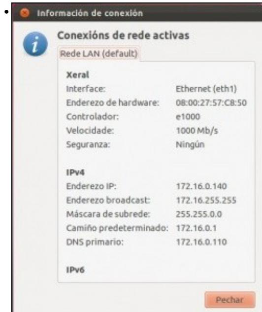
A conexión de rede configurada.
