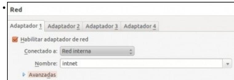
A MV **wclient** debe estar configurada cun único adaptador en modo **Rede interna** ou en modo de **Rede NAT**
